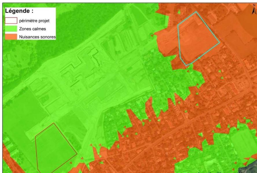
Figure 3: Exemple hypothétique d'une construction en zone agricole, avec les périmètres proposés en rouge et bleu, les zones calmes et propices à la détente en vert et les zones où les nuisances sonores excèdent 45 dB en orange.
