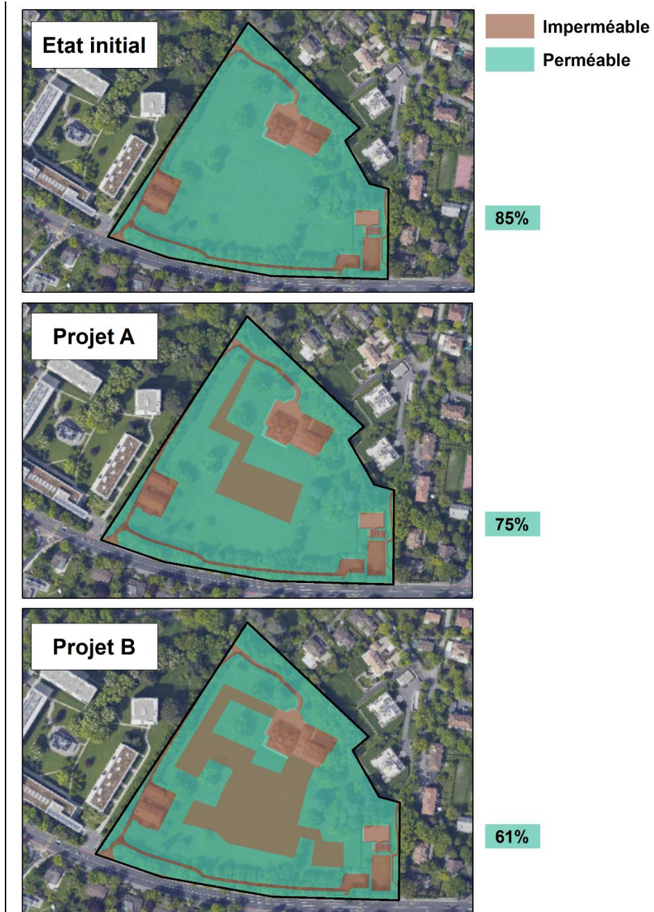
Figure 3: Comparaison de la part de surface perméable entre l'état initial et deux variantes de projet.
