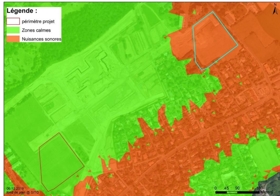
Figure 3: Exemple hypothétique d'une construction en zone agricole, avec les périmètres proposés en rouge et bleu, les zones calmes et propices à la détente en vert et les zones où les nuisances sonores excèdent 45 dB en orange.
